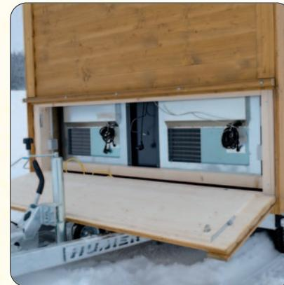
Praktische Revisionsklappe für Stromanschluss und zur Reinigung der Kühlung.
